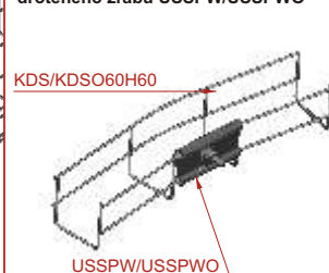
Príklad použitia spojky drôteného žľabu USSPW/USSPWO
